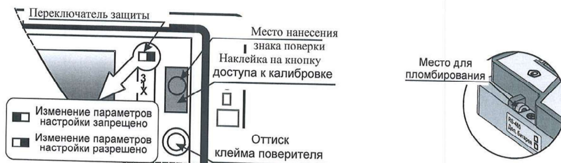
Рисунок 2 – Места пломбирования вычислителя и нанесения знака поверки
